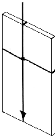
Ilustração 19: Forma correta de amarrar coletor para içamento.
